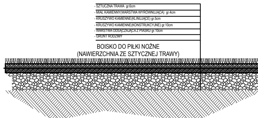
TYPOWY PRZĘKRÓJ PRZĘZ BOISKO DO PIŁKI NOŻNEJ Z NAWIERZCHNIĄ ZE SZTUCZNEJ TRAWY, SKALA 1:25
