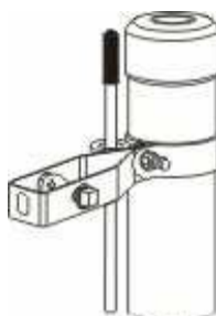
Rys.2 – Napinacz z opaską.
